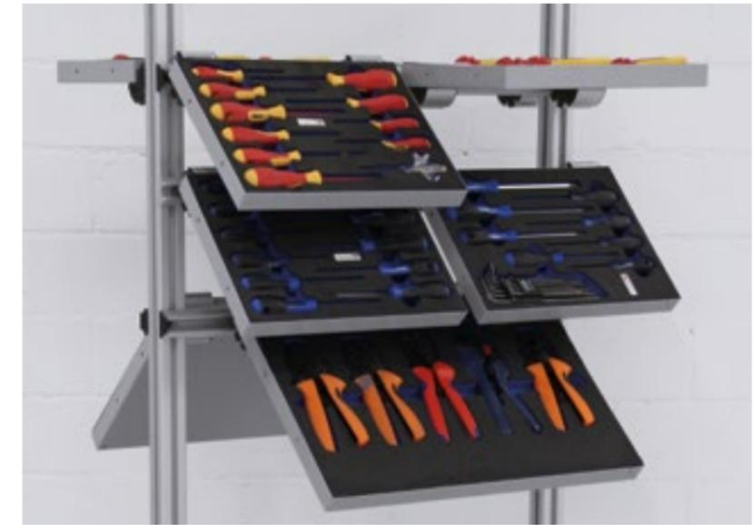
Grâce à notre propre expérience de la production LEAN, nous sommes en mesure de développer des postes de travail optimisés pour nos clients selon les principes LEAN. Il peut s'agir d'îlots de production ou de lignes de production, adaptés au produit à fabriquer. Ici, les processus logistiques sont pris en compte ainsi que le souci de rendre les erreurs impossibles.
