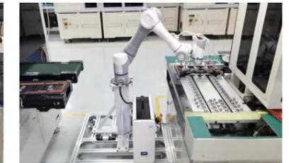
Chargement et déchargement (manutention) pour le soudage de noyaux de batteries
