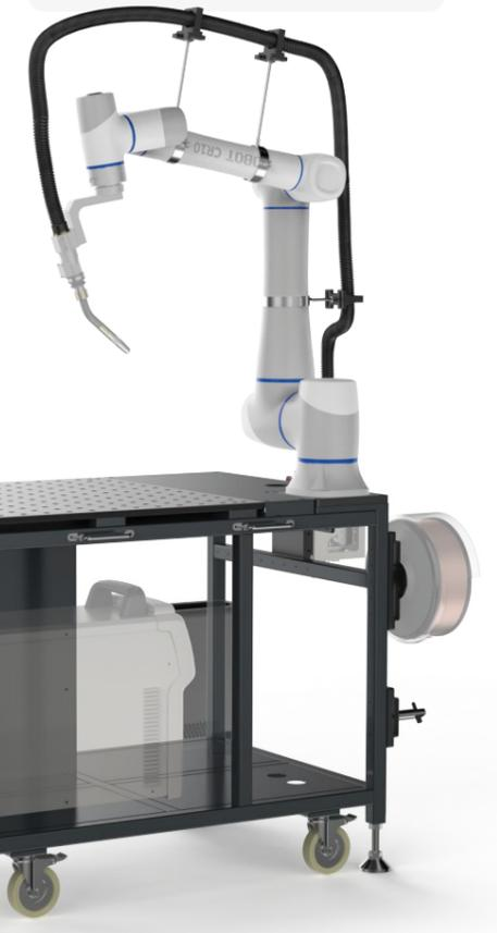
Le robot s'adapte à plus de 10 marques de machines à souder et offre plusieurs méthodes de communication telles que DeviceNet, Modbus et des signaux analogiques
