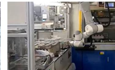
Chargement/déchargement pour l'encapsulation plastique de semi-conducteurs
