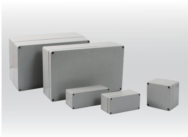
ROSE Polyestergehäuse für Bahnanwendungen sind ausgerichtet auf die Anforderungen der EN 45545. Sie bestehen aus einem speziellen duroplastischen Material, das im Brandfall weder schmilzt noch abtropft und das eine moderate Rauchentwicklung aufweist. Gemäß Prüfung in einem akkreditierten Prüflabor erzielt das Material hervorragende Ergebnisse in 3 der 4 Prüfkategorien und kann somit in nahezu allen Bahntechnik-Projekten Verwendung finden.
