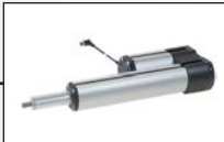
LZ 60 E-Zylinder Hub max: 597 mm Fd max: 4.000 N Fz max: 4.000 N Vmax: 50 mm/s
