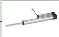
LZ 80 E-Zylinder Hub max: 1.005 mm Fd max: 10.000 N Fz max: 10.000 N Vmax: 13 mm/s
