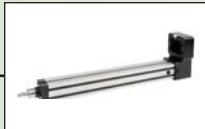
SLZ 63 TR FL/PL E-Zylinder Hub max: 1.000 mm Fd max: 15.000 N Fz max: 15.000 N Vmax: 58 mm/s
