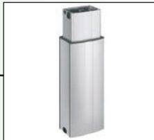
RK Powerlift Hub max: 500 mm Fd max: 3.000 N Fz max: 1.500 N Vmax: 50 mm/s
