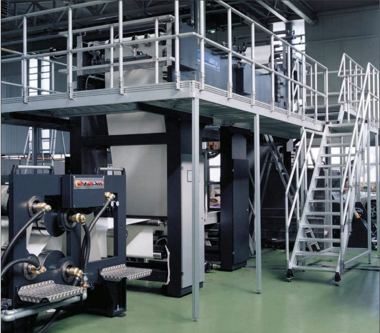
Arbeitsbühne mit Aufgang an einer Rollenoffset-Maschine.
