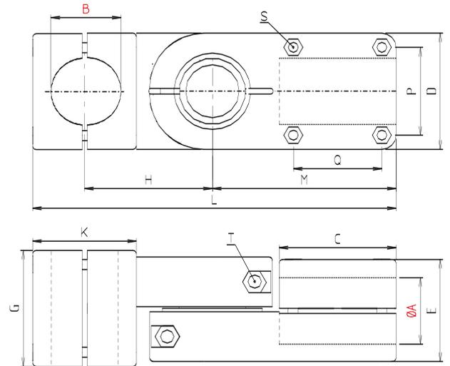
180° Schwenkbereich, stufenlos
