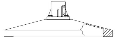
X = Hohlraum mit Betonplatte (m=14 kg)
